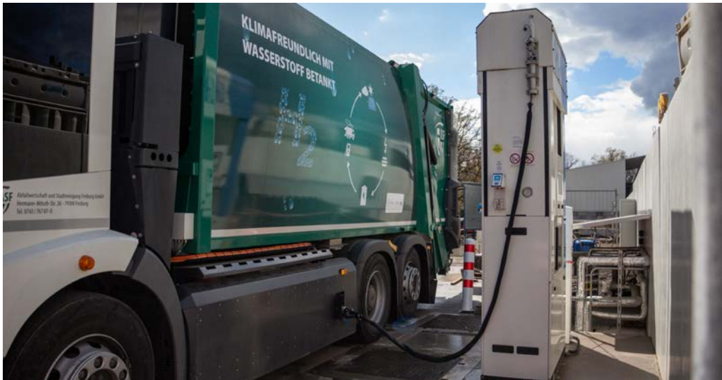
WASSERSTOFFBETANKUNG EINES MÜLLKRAFTWAGENS
